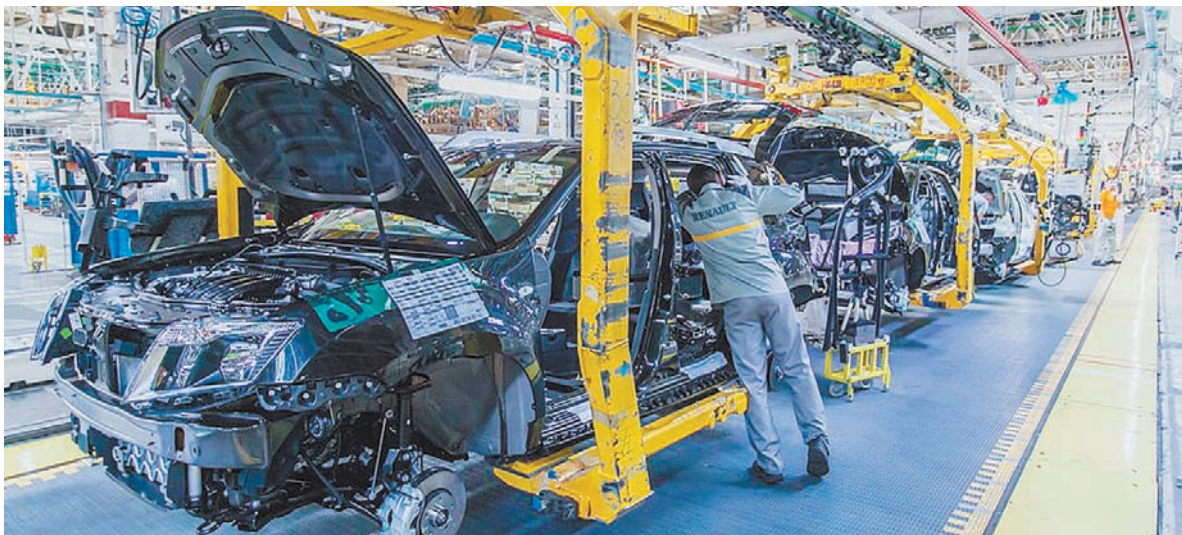
Одна из особенностей работы на заводе: сборка машин осуществляется на ходу.
