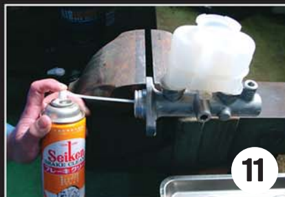
После промывки жидкостью Seiken Brake Cleaner, тщательно продуйте и просушите цилиндр и его запчасти перед сборкой.
