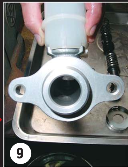
Чтобы не поцарапать цилиндр, поршень доставайте аккуратно, проворачивая его вокруг оси.
