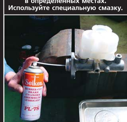
Проверьте ход поршня, убедитесь что сборка проведена правильно.
