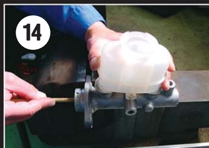
После промывки жидкостью Seiken Brake Cleaner, тщательно продуйте и просушите цилиндр и его запчасти перед сборкой.
