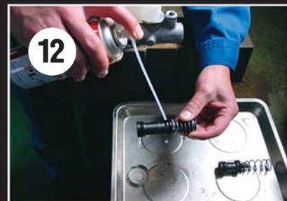
Смажьте внутреннюю часть цилиндра, поршня, шайбу, оставляя минимально тонкий смазочный слой плёнки, избегая её скопления в определённых местах. Используйте специальную смазку.
