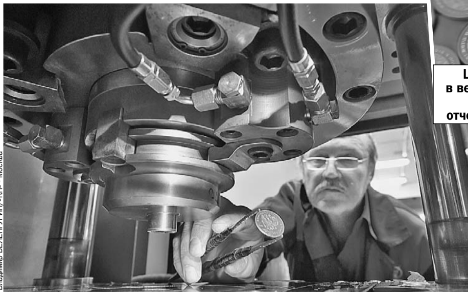
Каждую памятную монету из драгметаллов штампуют вручную. Это позволяет добиться более высокого качества.
