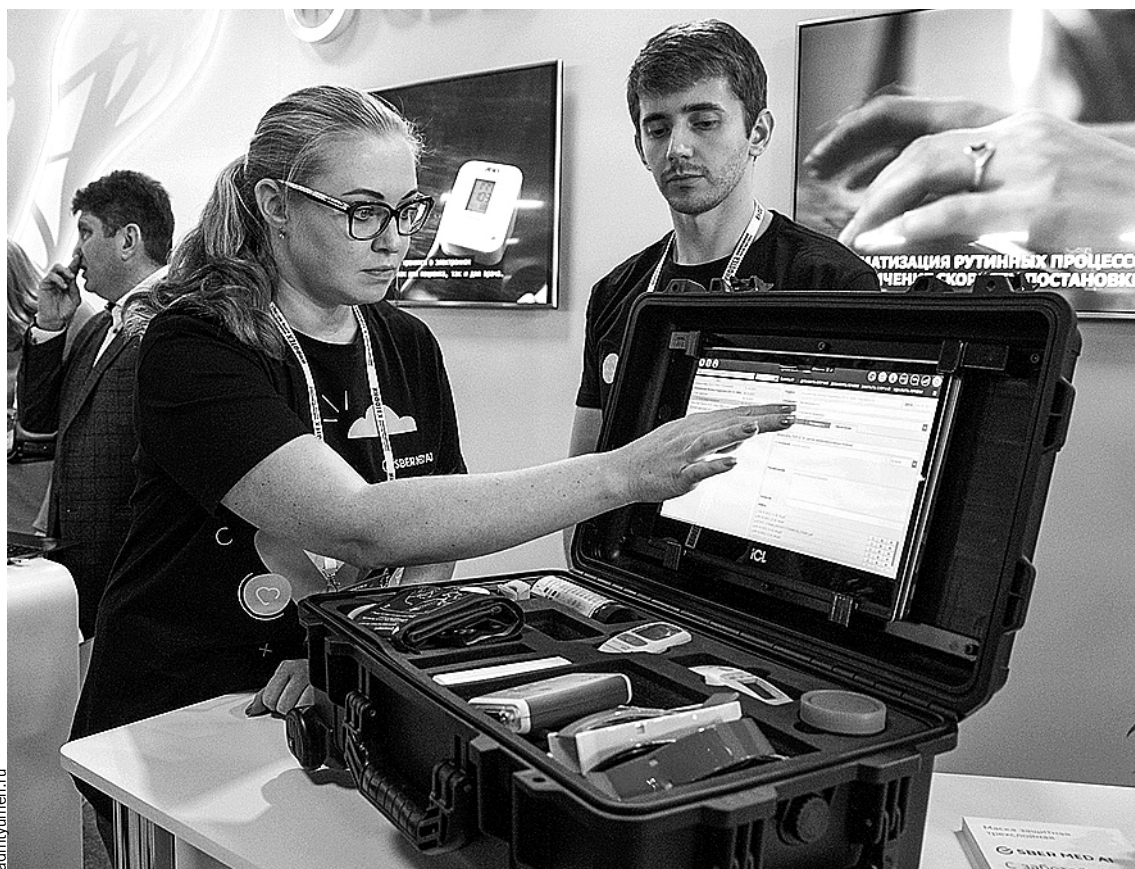
В специальный чемодан помещены тонометр, экспресс-сигнализатор глюкозы, холестерина, электрокардиограф, термометр, пульсоксиметр.
