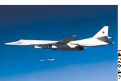
Ту-160 во время пуска ракеты Х-101, поражающей цели на расстоянии в несколько тысяч километров.
