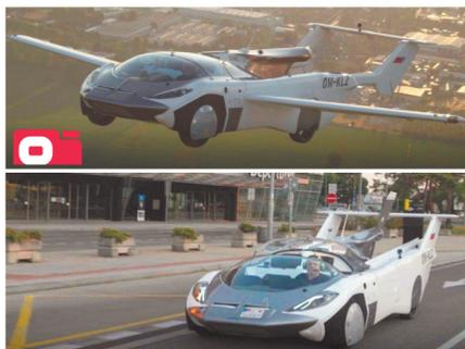
**Летающая машина AirCar** совершила первый межгородской перелет — она превращается из автомобиля в самолет за две минуты. Перед стартом крылья выдвигаются, а спойлер превращается в хвост. AirCar успешно совершил испытательный перелет длительностью 35 минут между словацкими аэропортами в Нитре и Братиславе. Разработчики заявляют, что на создание летающего авто ушло около двух лет и двух миллионов евро.
