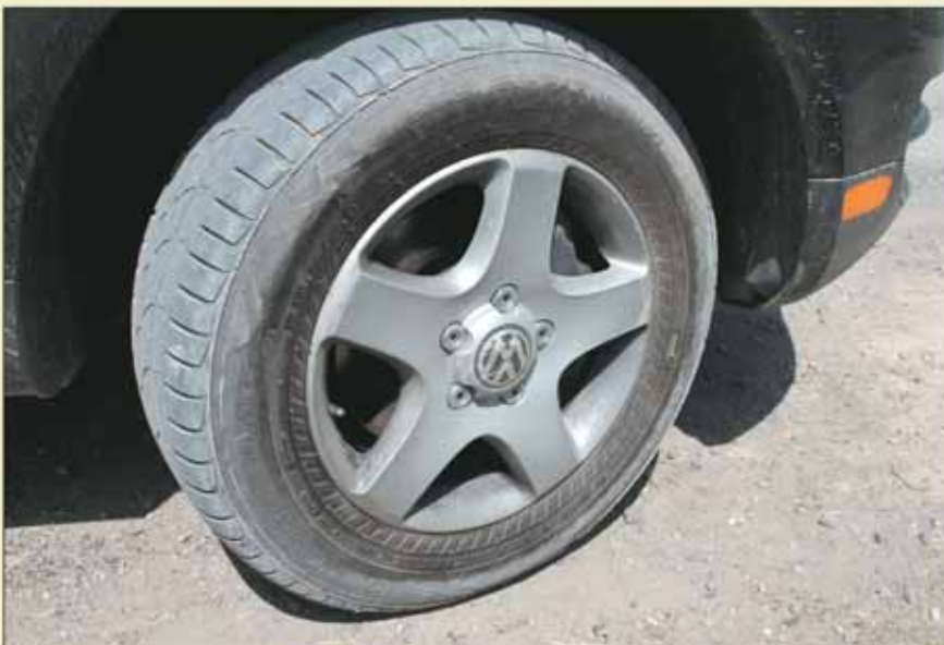
В состав резиносмеси боковин включены арамидные волокна
