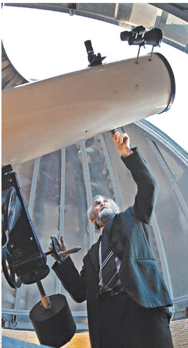
Корпус телескопа Газраил Кедакоев построил из молочных фляг.
