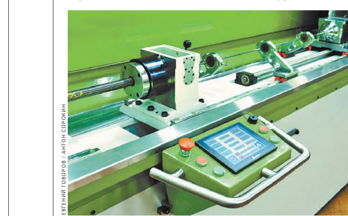
Точность совпадения всех элементов по оси сверления на глубину 1300 мм у этого станка менее микрона.
