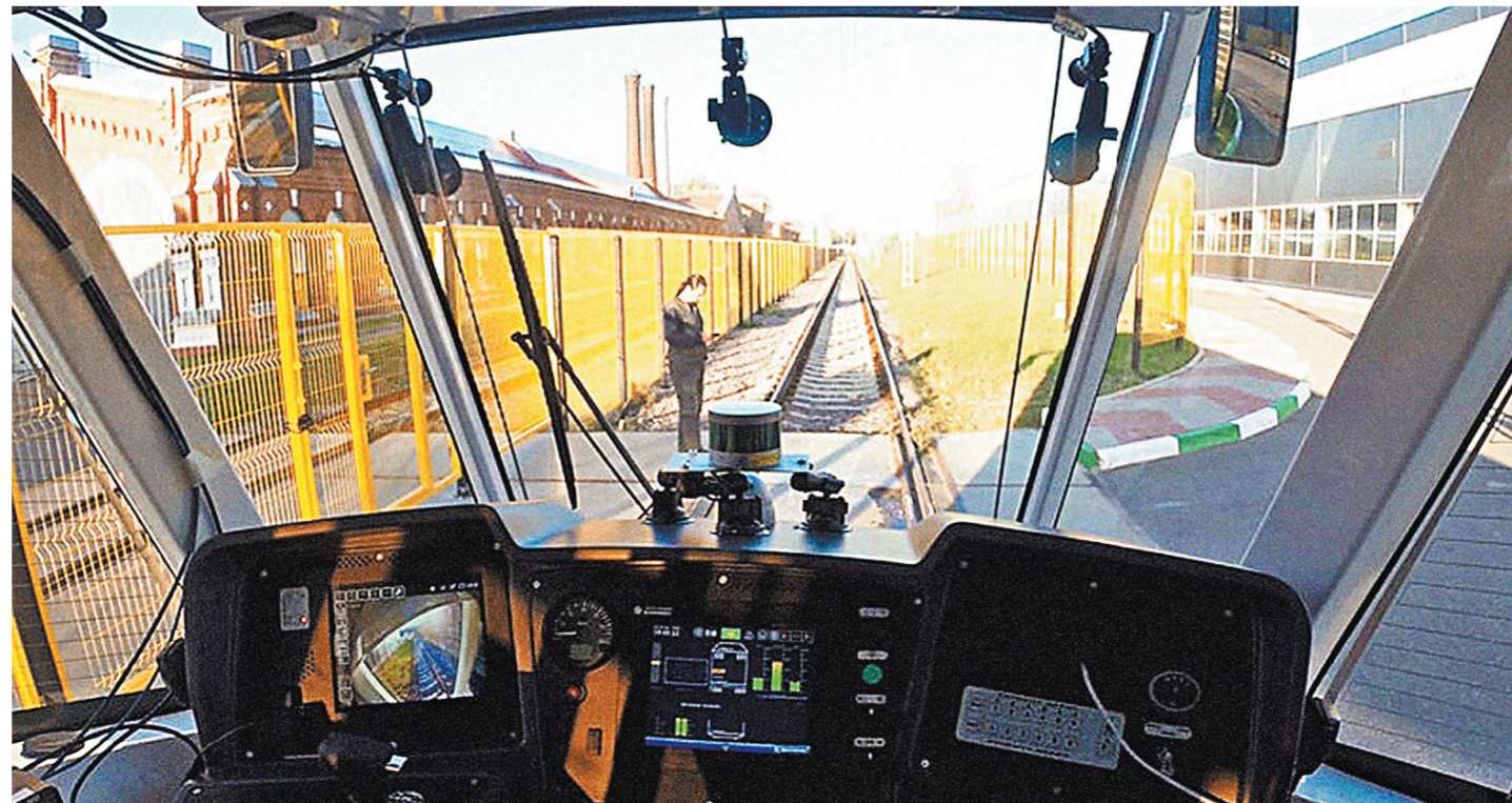
Датчики и радары — «глаза» беспилотного трамвая. Если они видят препятствие на путях, вагон сразу же тормозит.
