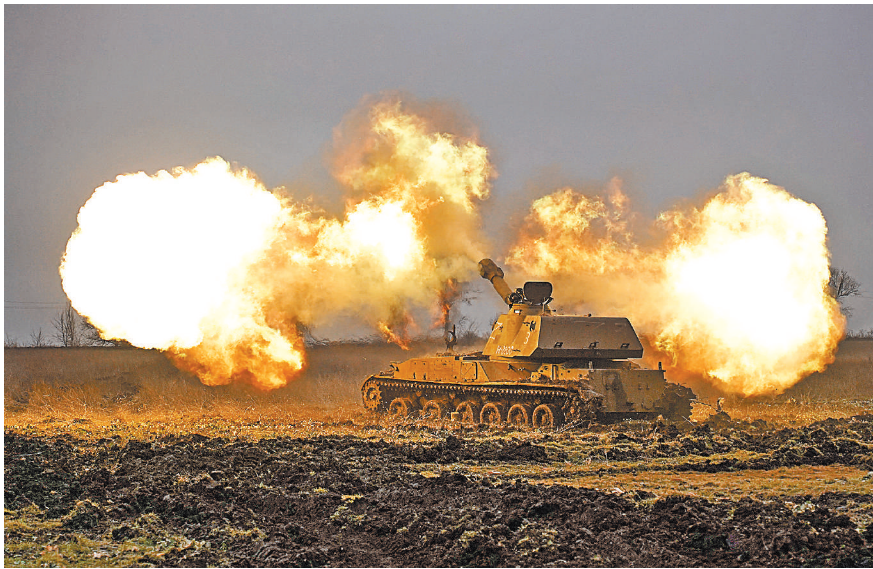
Для уничтожения бронетехники и опорных пунктов ВСУ экипаж самоходной гаубицы 2С3 «Акация» использует 152-мм орудие, способное стрелять на дальность более 20 километров.
