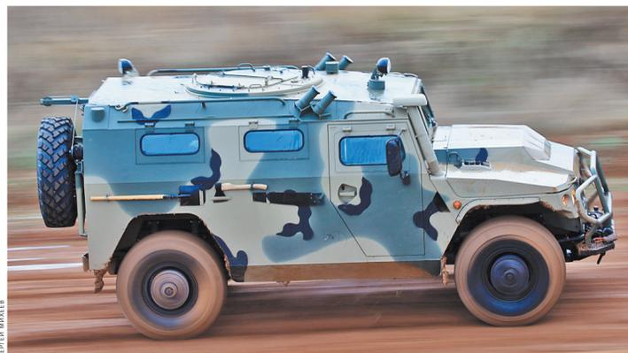
Броневомобиль «Тигр» отличается качественным бронированием, подвижностью и высокой проходимостью.
