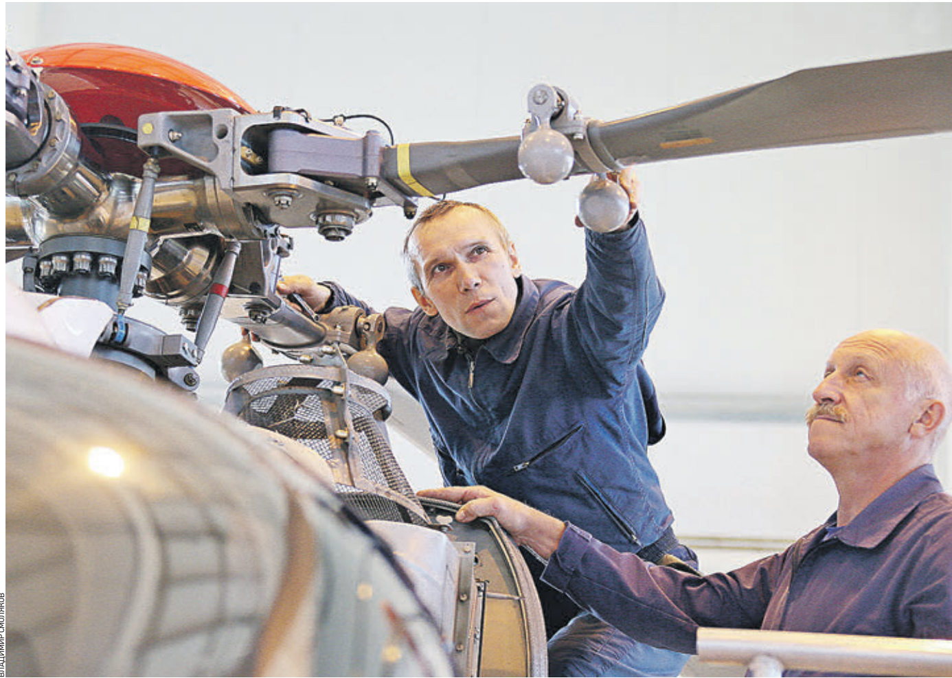
Вчера 11:07 Техники Олег Тимофеев (слева) и Владимир Горкунов (справа) проводят осмотр винта медицинского вертолета Московского авиационного центра
