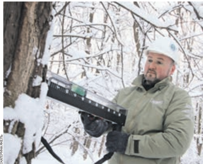
Вчера 15:34 Ведущий эксперт Алексей Анциферов обследует дерево с помощью резистографа
