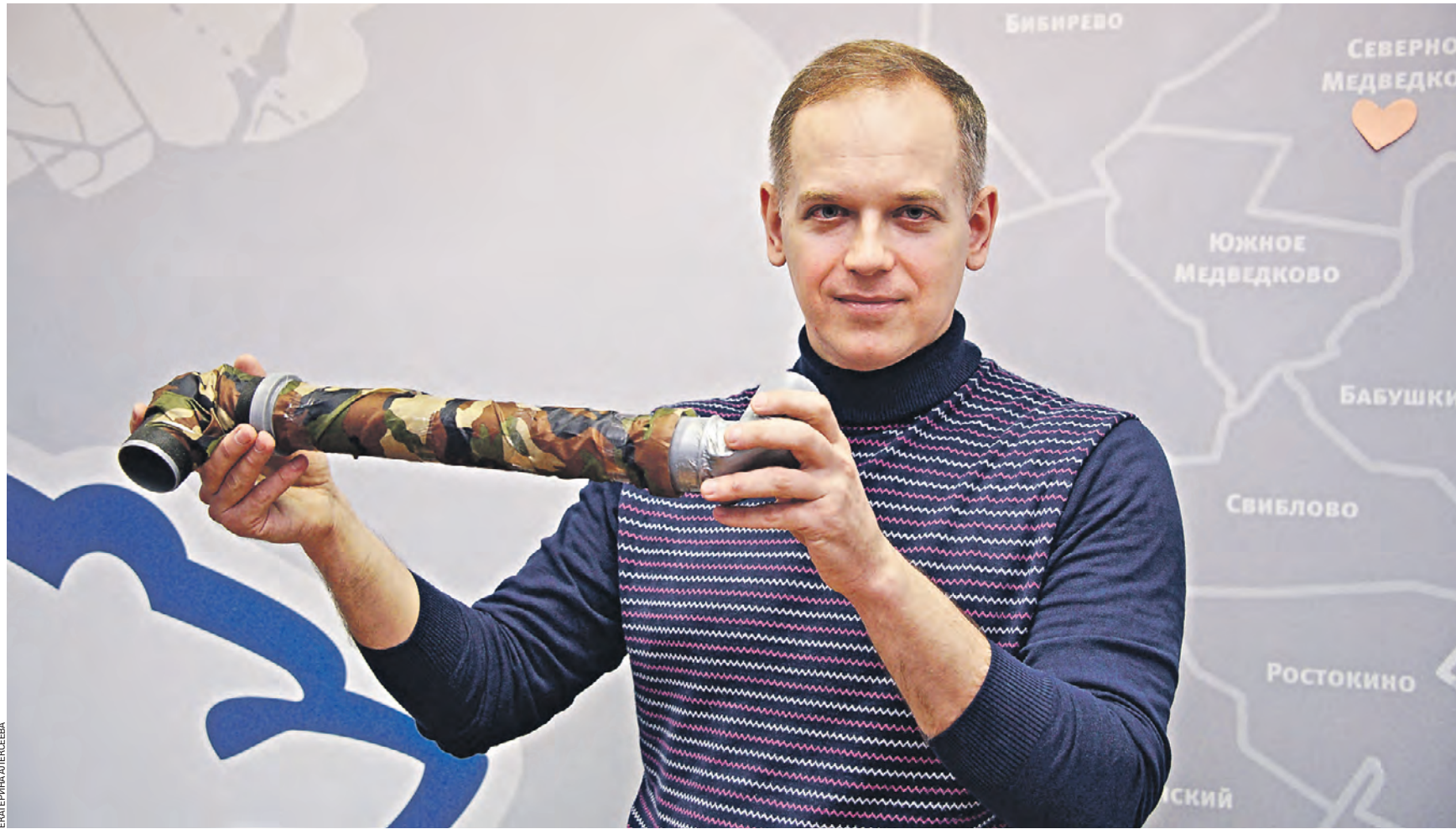
Вчера 12:35 Столичный волонтер из Северного Медведкова Максим Хромцов с изготовленным окопным перископом для участников спецоперации. Такое оптическое устройство москвич сделал из термопластовой трубы, соединительных элементов и небольших прямоугольных зеркал
