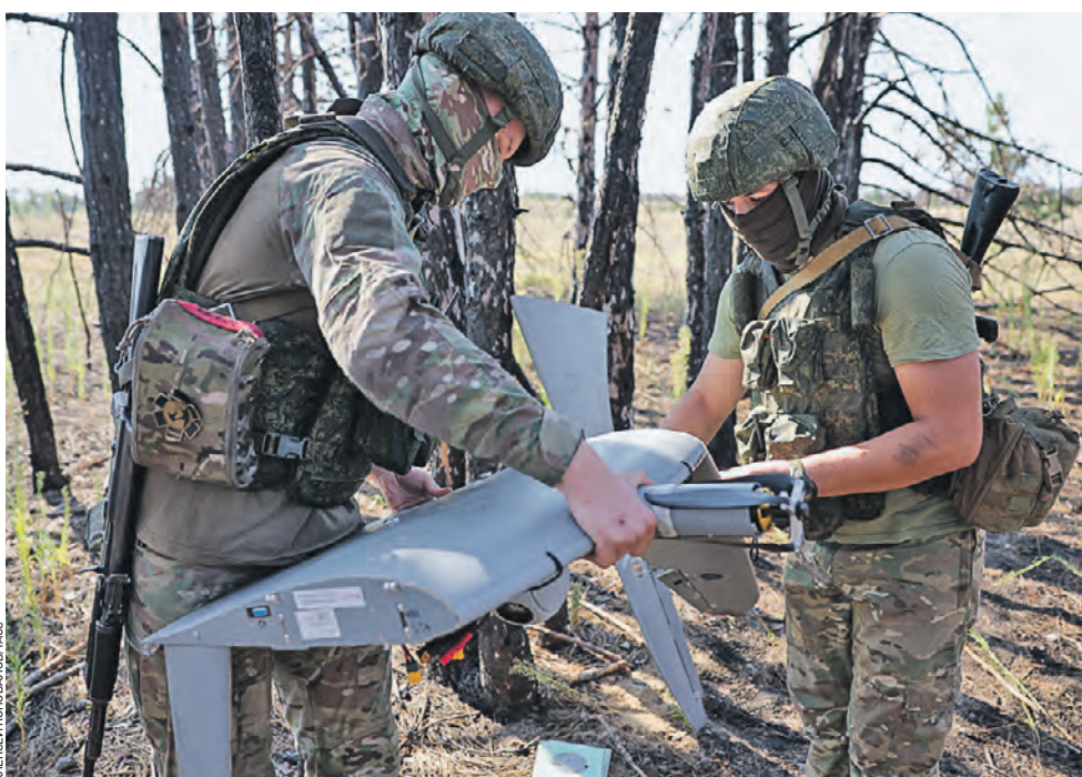
25 августа. Работа расчета БПЛА Supercat в Херсонской области на Кинбурнской косе в зоне проведения специальной военной операции. В задачи подразделения входит аэрозондирование территории на правом берегу Днепра, подконтрольной ВСУ, а также корректировка артиллерийского огня. Такой дрон может находиться в воздухе до 4,5 часа, передвигаться со скоростью от 65 до 120 километров в час, а дальность полета составляет не менее 240 километров.
